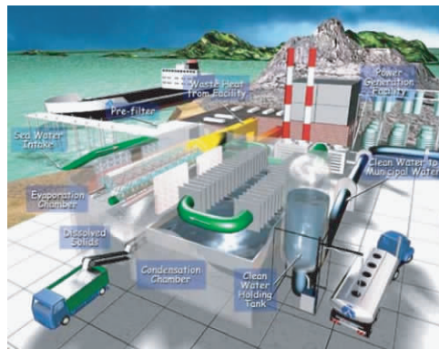
图 23 小型核能进行海水淡化示意图
