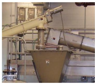
反应装置进料前设置有全封闭的缓冲料斗,缓冲料斗底部是预搅拌螺旋。这个"预搅拌螺旋"完全不同于传统意义上的"搅拌机"。
